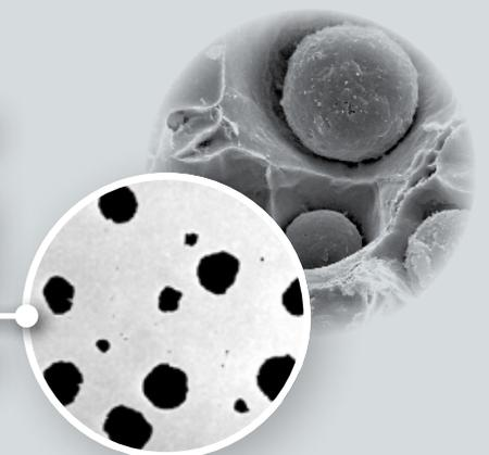
La hierro dúctil es una aleación de Hierro-Carbono-Silicio. Debe sus notables características mecánicas a la forma esferoidal del grafito obtenida mediante tratamiento con magnesio. La forma esférica del grafito aporta una excelente resistencia a la formación de fisuras, al contrario de las láminas de grafito en los hierros grises.
